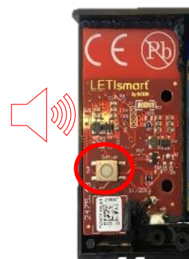
fig.8- Lato interno TAG PERSONAL posizione pulsante
